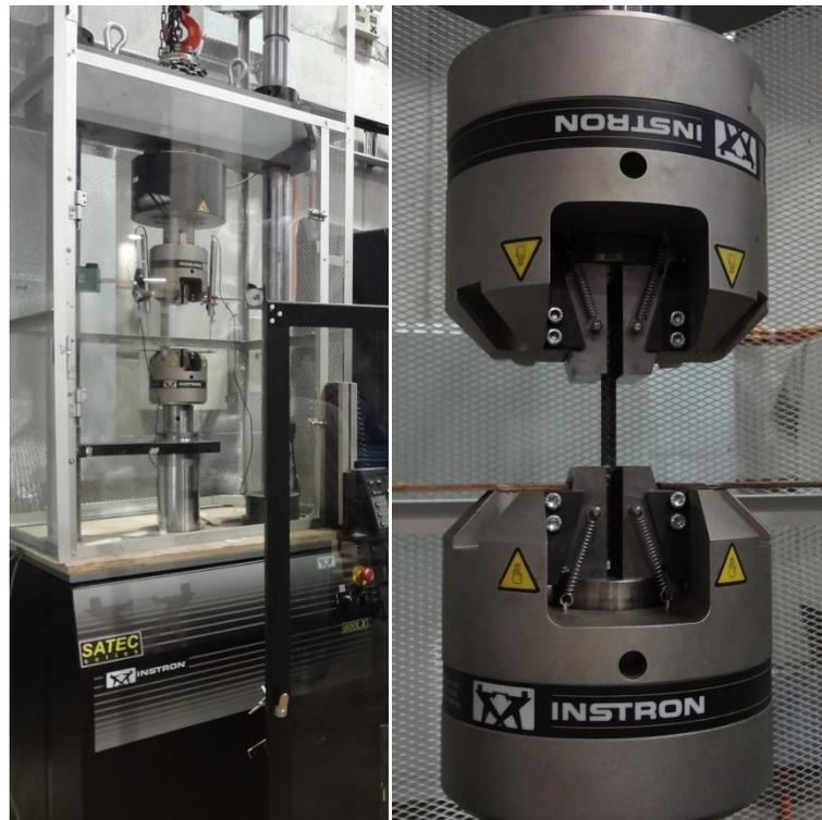
Figura 10: Máquina universal para pandeo Instron modelo 600LX de 60 toneladas, (a) mordazas mecánicas, capacidad 10 [T], (b) mordazas hidráulicas, capacidad 25 [T]-
