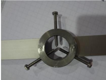
Figura 15: **anillos con tornillos**
