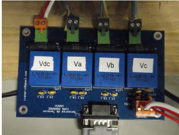
Figura 4.11: Tarjeta transductores de tensión.
