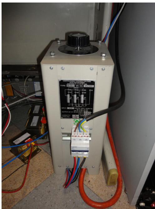
Figura 4.2: Autotransformador trifásico variable.
