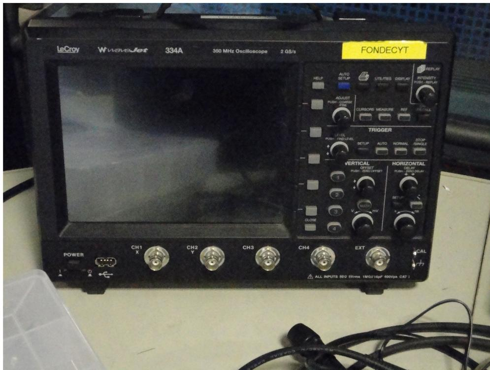
Figura 4.3: Osciloscopio marca LeCrow, resolución 350[MHz]
