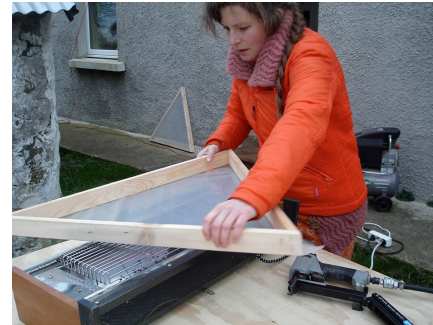
Construcción del módulo triangular con el material plástico de la cubierta.
