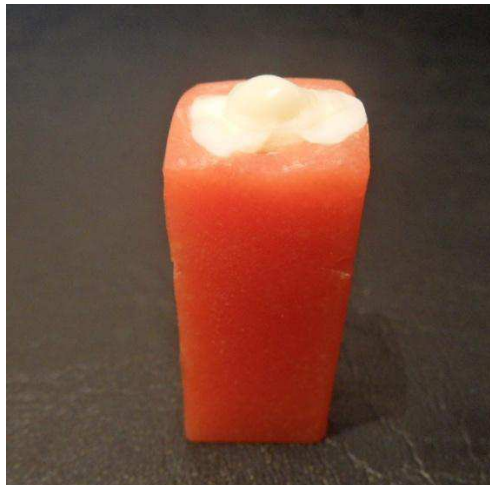
Figura 7: Falla cohesiva de la probeta de resina.
