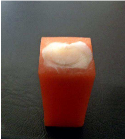
Figura 6: Falla cohesiva del cemento.
