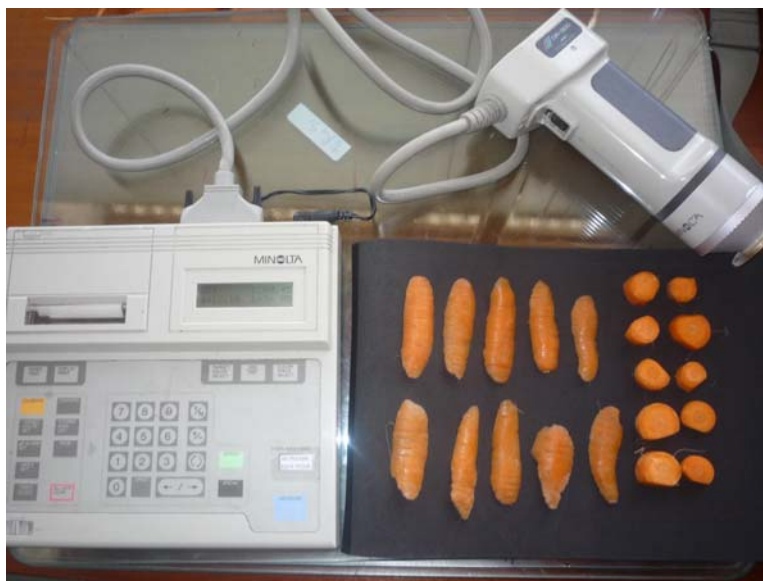
Figura 1. Colorímetro CR-300, y muestras de cortes de zanahorias medidas
