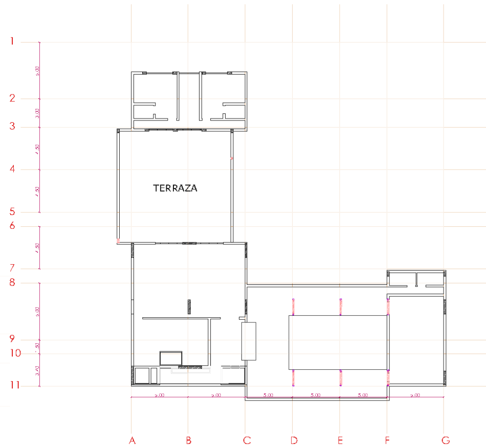
Planta Estructura Segundo Nivel
