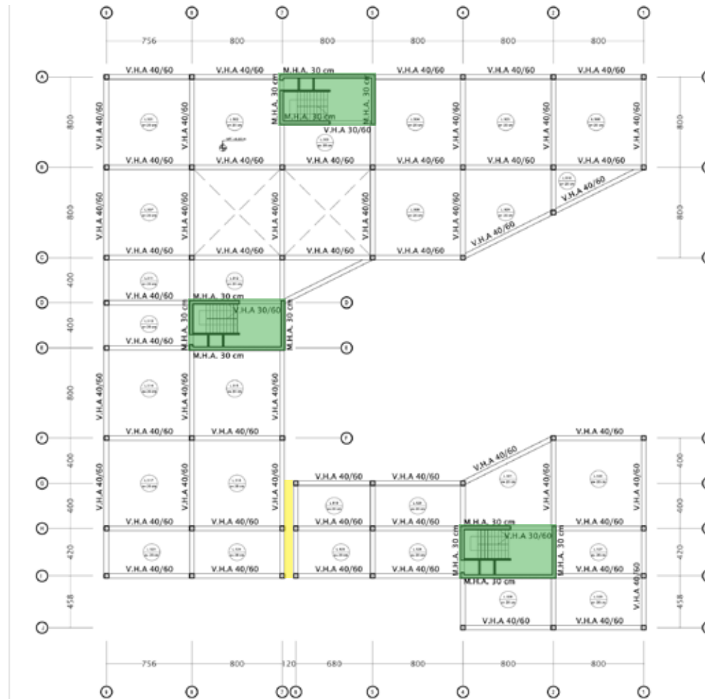
Planta Estructura 3er Nivel, Esc: Sin escala Imagen referencial acorde al estado de avance del proyecto a la fecha de entrega de la memoria.
