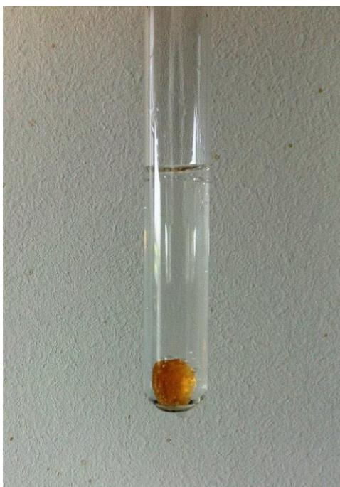
**Figura 3.** Muestra de Cu(38)/PMMA incorporada en caldo de cultivo.
