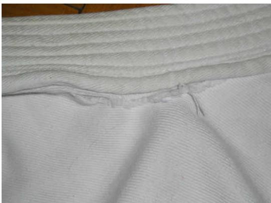
El último caso es una ruptura que se produce por falla de fabricación, en donde una leve tensión ocasiona la separación de las partes del cuello que componen el traje.
