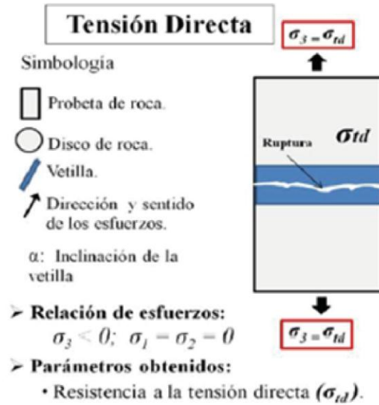
Figura 15. Figura esquemática de ensayo de tracción directa. Imagen extraída de De Los Santos (2011).
