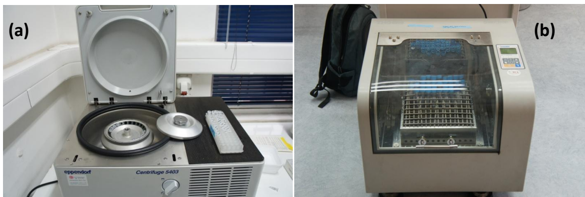
Figura A 7: (a) Rotor utilizado para centrifugar las muestras tomadas. (b) Agitador rotatorio utilizado en la reacción de sacarificación. Condiciones de operación: 250 RPM, 50°C por 72 horas.
