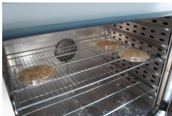
Figura A 5: Ensayo para determinar la humedad del material. Las muestras fueron ubicadas en una estufa a 65°C hasta que ya no perdían masa.
