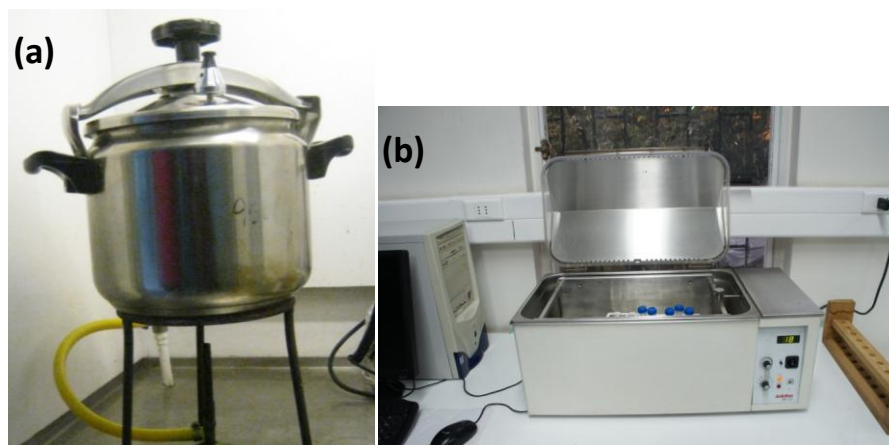
Figura A 4: Montaje de los pretratamientos. (a) Recipiente utilizado como autoclave para pretratar con ácido diluido las muestras a 120°C. (b) Baño de agua utilizado para pretratar por COSLIF las muestras a 50°C.
