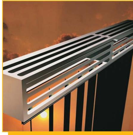
Las ventilas superior e inferior son independientes una de otra y se operan por separado y en forma horizontal, en su interior cuentan con un perfil perforado el cual al ser desplazado por el usuario, permite cerrar y abrir el paso de aire al sistema.
