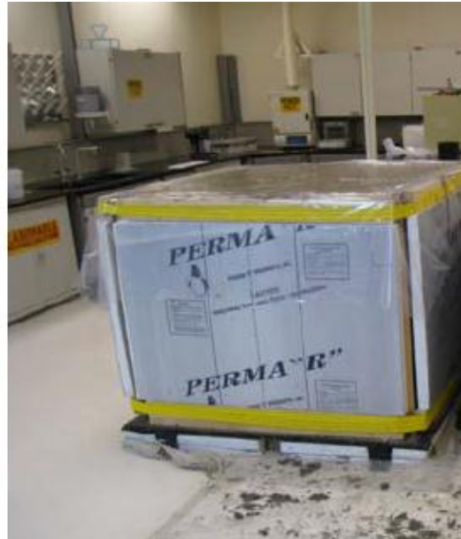
Figura C-3: Bloque de hormigón terminado, con el encofrado de madera contrachapada y la capa de poliestireno.
