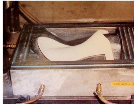
En una instancia del proyecto se propuso utilizar un casco de polietileno inyectado, con el propósito de industrializar el proceso y así bajar los costos. Pero tras el análisis de las proyecciones se concluyó que la inversión inicial de la matricería en acero (de 135 millones) no se justificaba ante la cantidad de monturas que se producirían al año.
