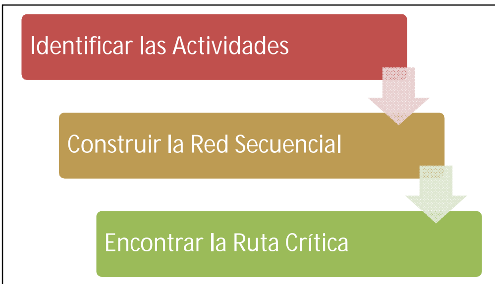
Figura 2.5. Diagrama algoritmo CPM
