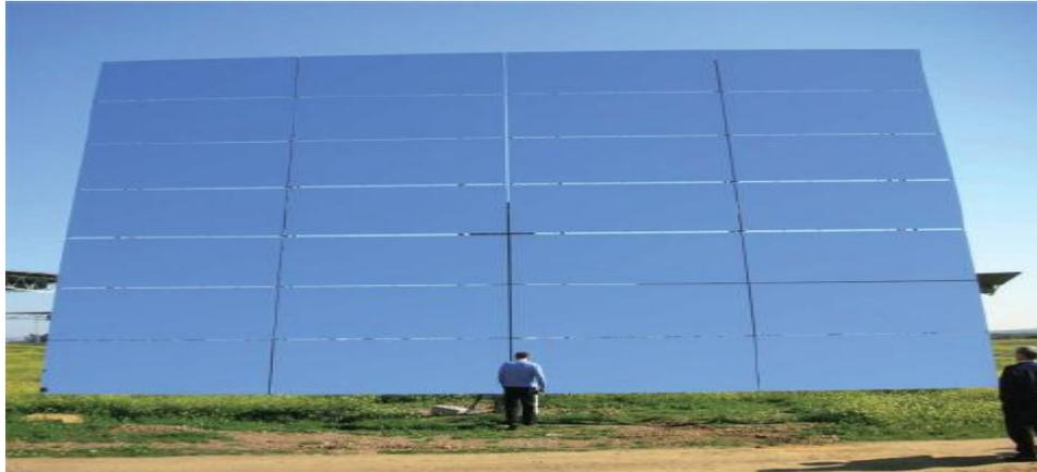
Figura 33: “Heliostato de Vidrio/Metal, PS-10 (España)” [20]
