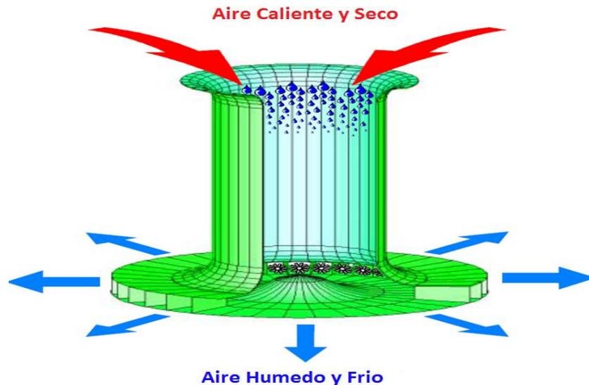
Figura 26: “Funcionamiento de una Torre de Corriente Descendente” [20]
