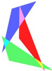
Figura 15 - Blending incorrecto para 3 triángulos entrelazados (caso 4).
