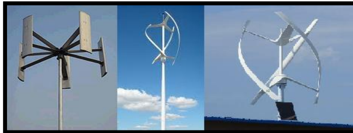
Figura 2.2: Aerogeneradores de eje vertical.
