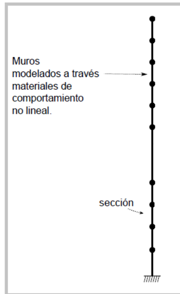
Figura 2-9 Esquema modelo muros aislados de hormigón.
