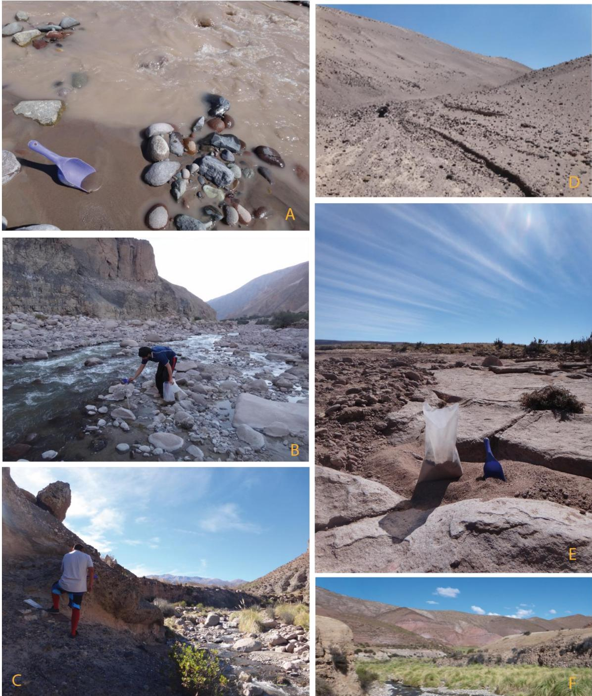
Figura 5. Fotos de muestreo de sedimentos. A) y B) Recolección muestra de sedimentos fluviales activos. C) Recolección muestra de sedimento fluvial preindustrial. D) y E) Recolección sedimento fluvial reciente. F) Quebrada Laco con cauce activo.
