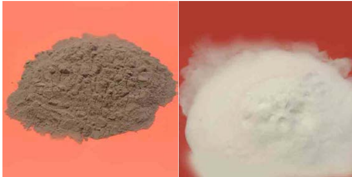
Ilustración 27 microballons fenólico y microballons vidrio.
