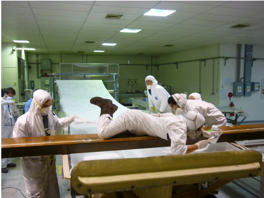
Ilustración 52 Complicaciones en laminado de carenado inferior Eolian 2.
