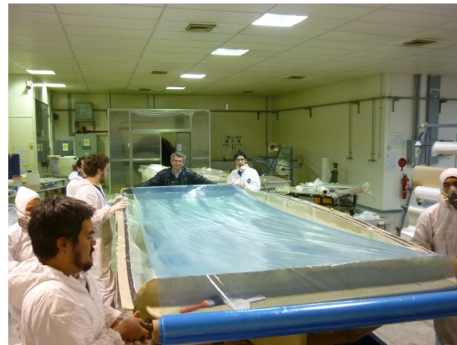
Ilustración 51 Aplicación de vacuum bagging.
