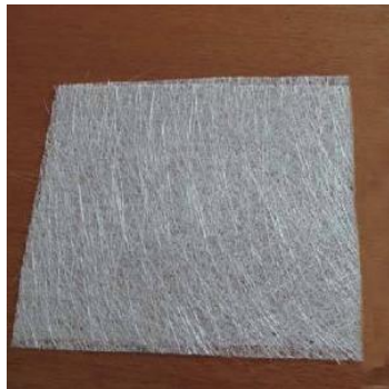
Ilustración 25 Mat de fibra de vidrio.
