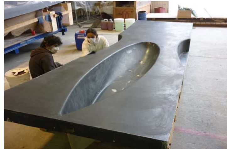
Ilustración 48 molde inferior Eolian2.
