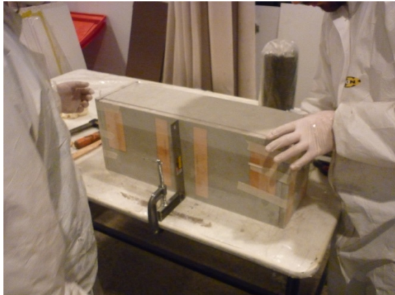
Ilustración 114 Laminado exterior caja de suspensión.
