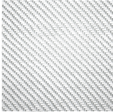
Ilustración 20 Fibra de vidrio E bidireccional twill.
