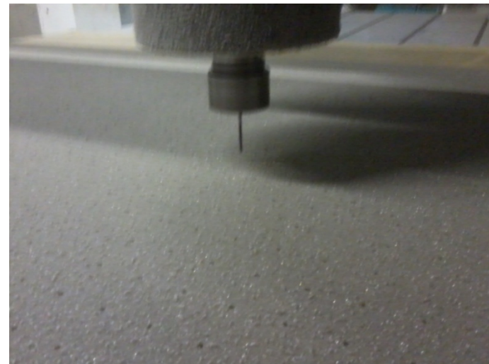
Ilustración 54 perforación de plancha divinicell en router CNC.
