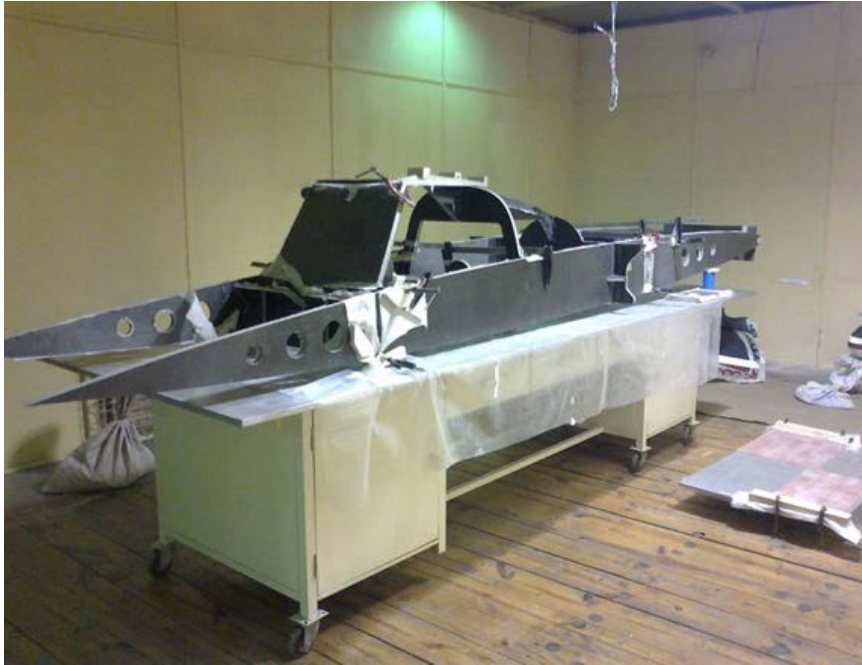
Ilustración 59 Estructura chasis pegada y curada.
