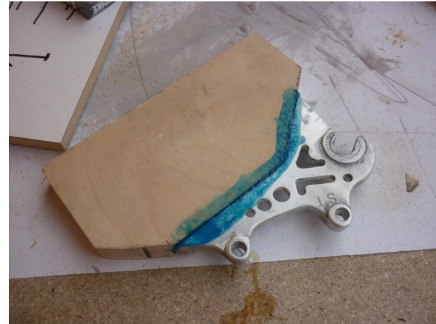
Ilustración 117 Puntera y sección de contacto unidas con adhesivo estructural de alto rendimiento.
