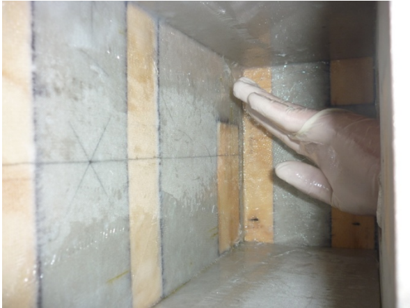
Ilustración 113 Laminado interior de caja de suspensión.
