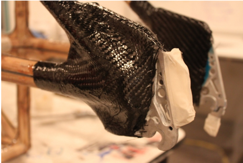
Ilustración 119 punteras laminadas en fibra de carbono.
