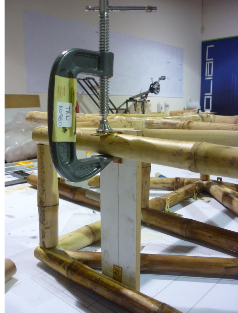
Ilustración 101 Posicionamiento de caras en matriz.
