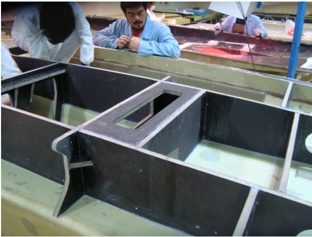
Ilustración 62 Pegado de chasis a carenado inferior.
