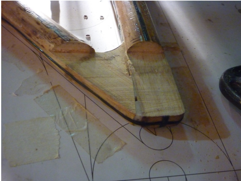
Ilustración 116 Corte de sección de chasis para unión de punteras.
