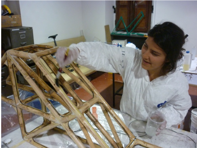
Ilustración 105 aplicación Roving carbono.
