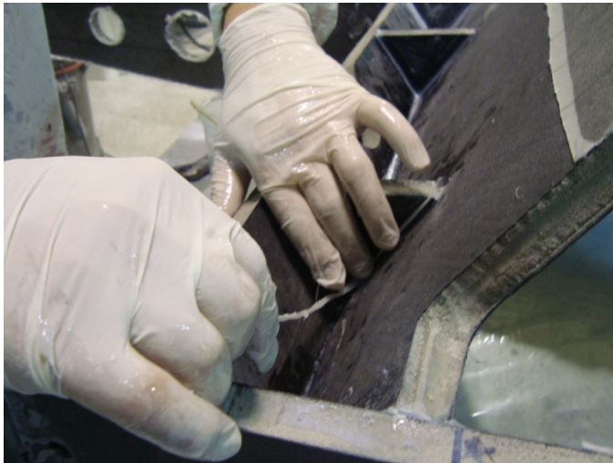
Ilustración 57 Armado chasis, refuerzo Roving.
