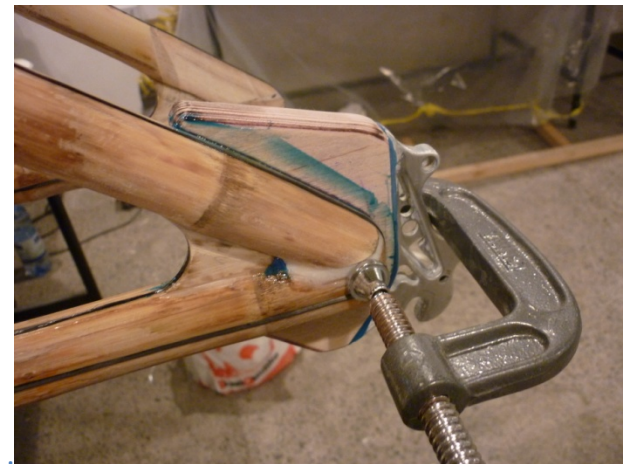
Ilustración 118 Pegado estructural de piezas de punteras al chasis.
