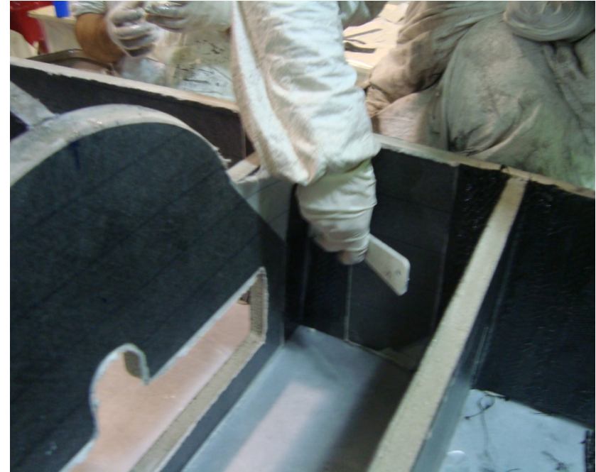
Ilustración 60 Laminado estructural de juntas del chasis.
