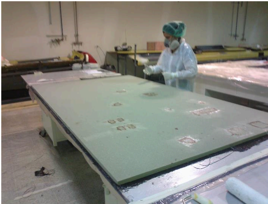
Ilustración 55 posicionamiento de insertos en panel.
