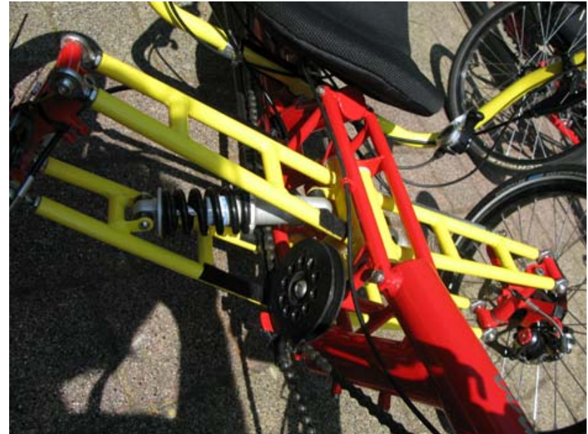
Ilustración 69 sistema de suspensión delantera Steintrike. Fuente: http://www.treehugger.com/bikes/modular-sporty-flexible-steintrikes-from-bike-revolution.html
