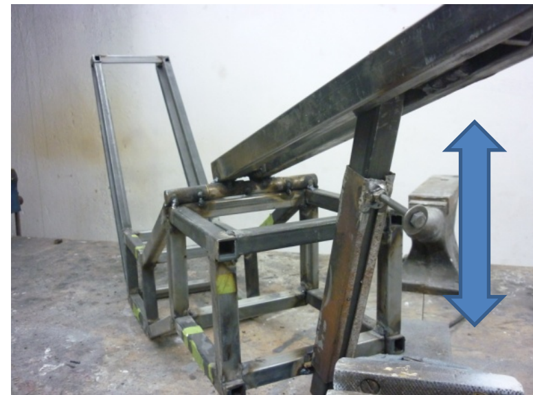
Ilustración 71 modelo analítico funcional, detalle de recorrido de altura. Fuente: elaboración propia.
