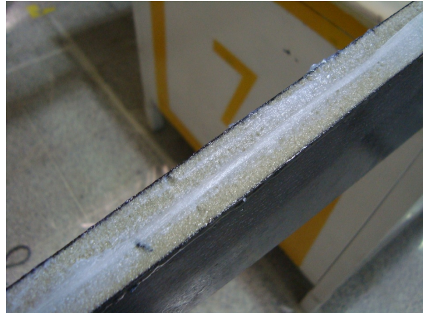
Ilustración 58 Detalle de Roving de vidrio en las juntas interiores.
