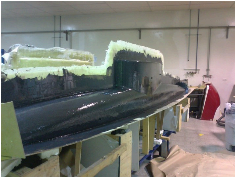
Ilustración 46 aplicación gelcoat g29.
