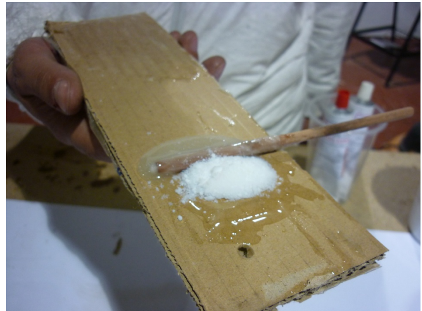
Ilustración 97 Adhesivo 5 minutos con carga de Aerosil.
