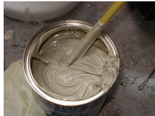
Ilustración 26 Masilla, matriz poliéster con carga de talco.
