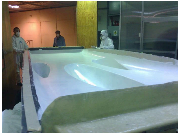
Ilustración 49 aplicación gelcoat poliéster.
