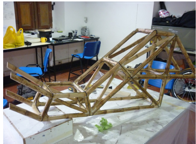
Ilustración 108 chasis coligue con amarre estructural aplicado.
