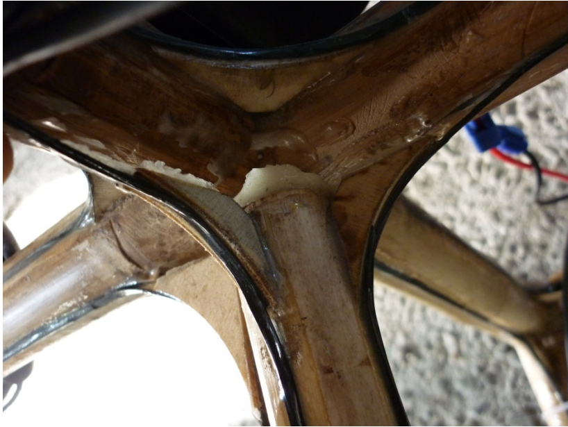
Ilustración 126 Detalle de fractura en culata trasera.
