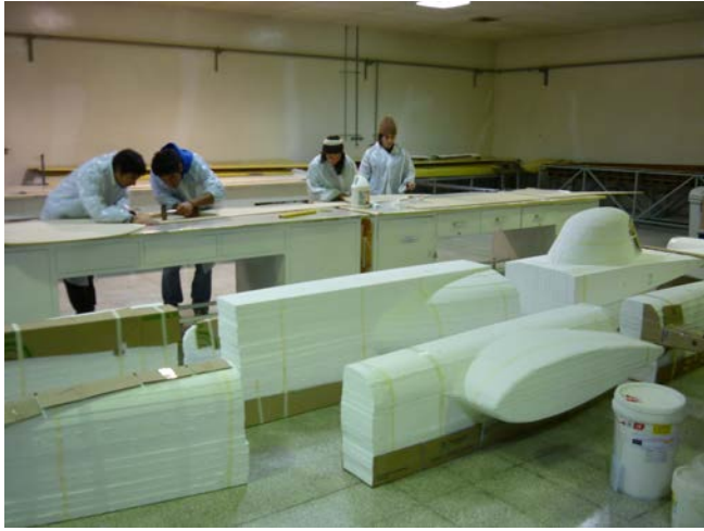
Ilustración 42 Piezas cortadas y calibradas, listas para ensamble. Enaer.
