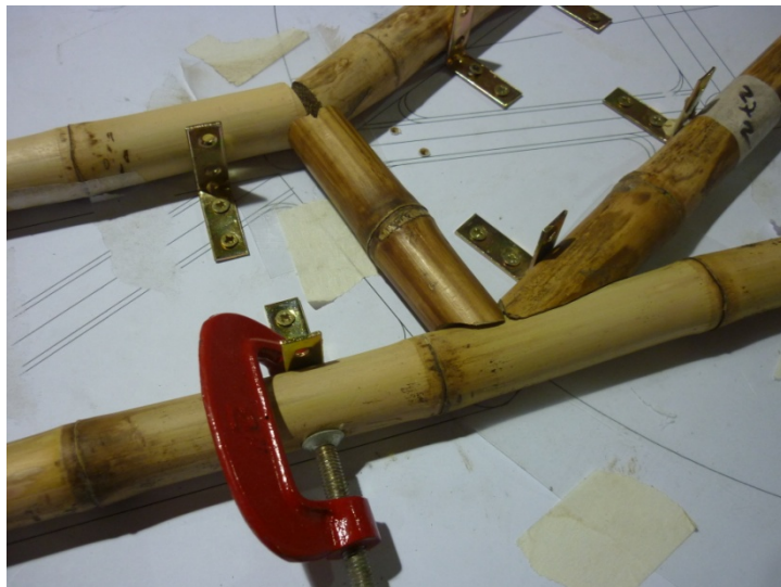
Ilustración 96 secciones prensadas a matriz
