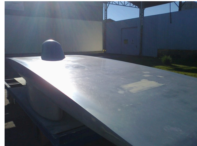
Ilustración 45 Master preparado para obtención de moldes.
