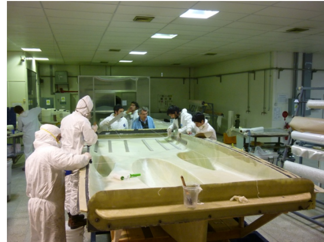
Ilustración 50 laminado carenado inferior Eolian 2.
