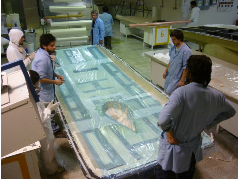
Ilustración 53 laminado carenado superior con stringers posicionados.
