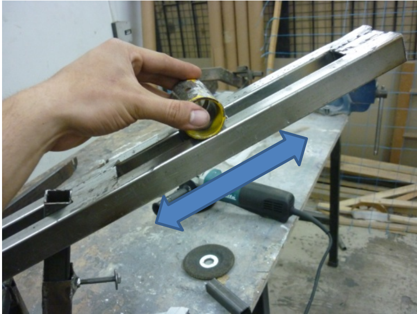
Ilustración 72 mecanismo de ajuste de longitud del modelo analítico funcional.
