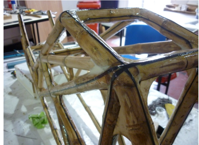
Ilustración 107 radios en juntas de coligue.
