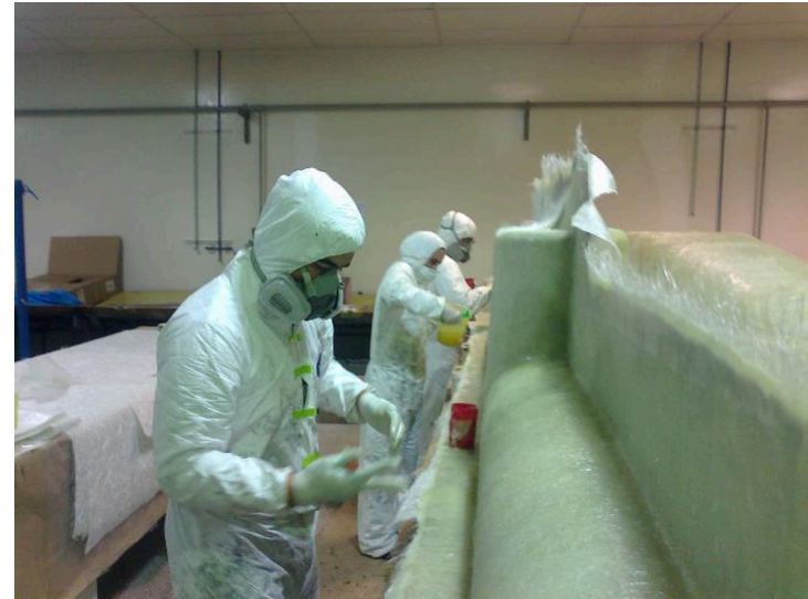
Ilustración 47 laminado de moldes en fibra de vidrio mat.
