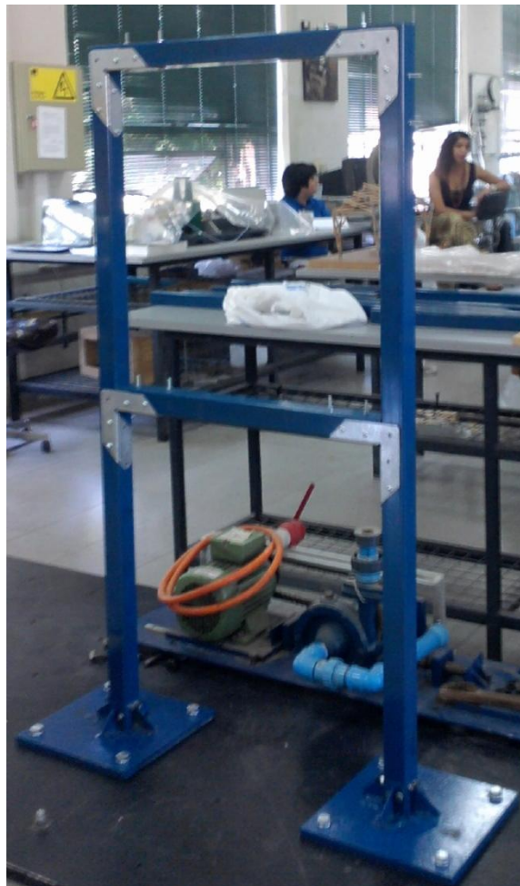
Figura 4.7 Montaje experimental de estructura sin daño
