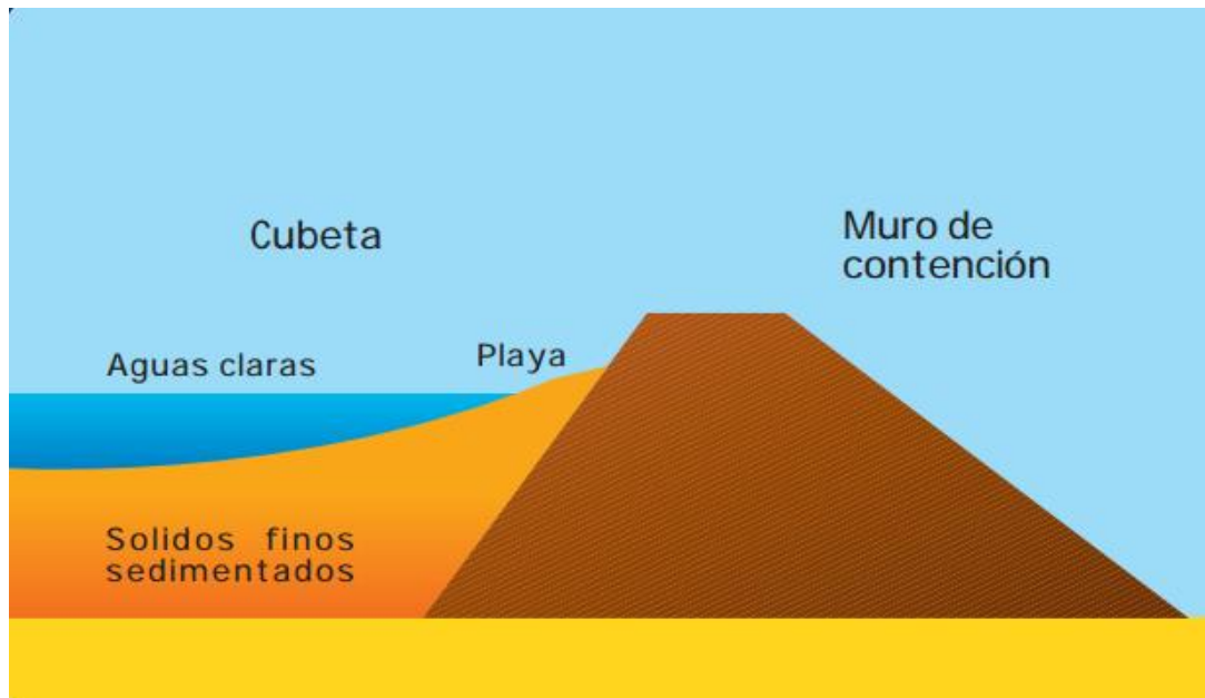
Figura 2.1 Esquema de un tranque de relaves (SERNAGEOMIN, SONAMI, & BGR, 2003)
