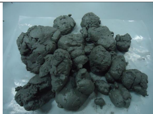
Figura 5.2 Figura 5.3 Aglutinación de partículas con un 20% de humedad.
