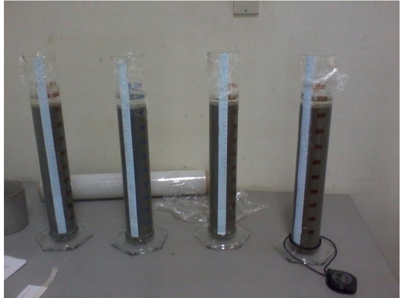
Figura 5.12 Ensayos de Sedimentación.
