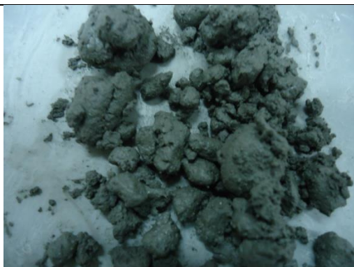
Figura 5.1 Aglutinación de partículas con un 17% de humedad.
