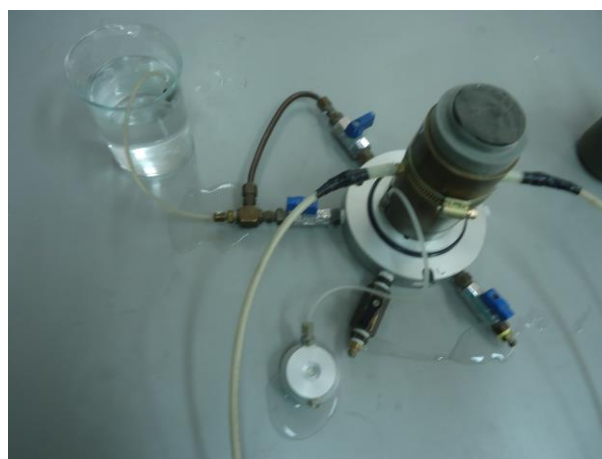
Figura 5.5 Montaje de ensayo de Permeabilidad en Pared Flexible. Se observa la probeta armada con la saturación de las líneas de la celda y el molde aún conectado a la bomba de vacío.
