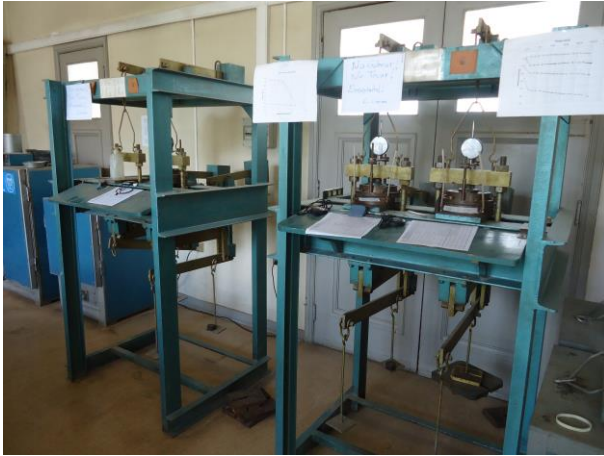
Figura 5.9 Montaje de ensayo Edométrico, celdas edométricas montadas en marcos de carga.
