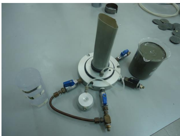
Figura 5.4 Montaje de ensayo de Permeabilidad en Pared Flexible. Se observa el cilindro para mantener la rigidez de la probeta, la membrana de látex instalada en el cap inferior y la pulpa lista.
