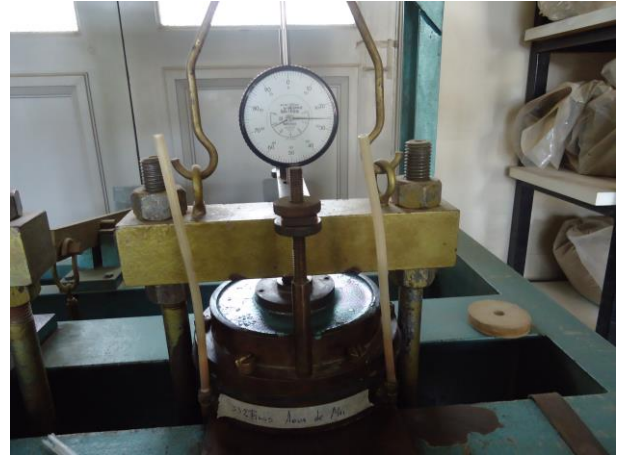
Figura 5.10 Montaje de ensayo Edométrico, montaje listo para ensayo.
