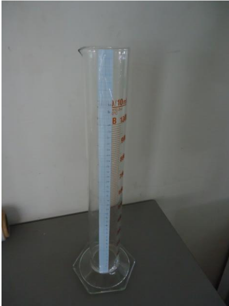
Figura 5.11 Probeta Graduada para ensayo de sedimentación
