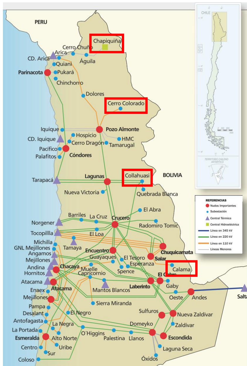
Figura 21: Unilineal simplificado del SING. Fuente: [18].
