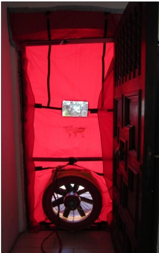
Figura 3.2: Blower door instalado
