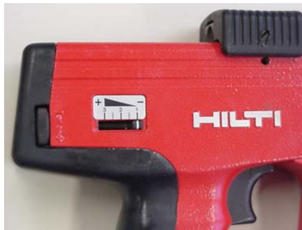
Figura 4.5. Ajuste potencia de Pistola Hilti.
