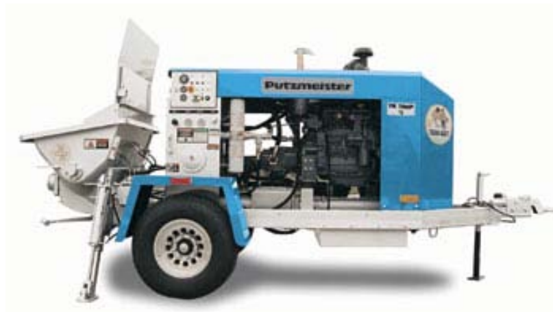
Figura 5.8. Bomba de hormigón.
