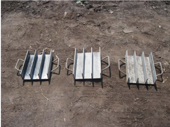
Figura 4.7. Moldes de vigas.
