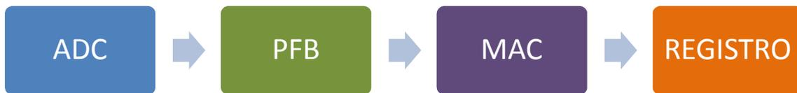
Figura 29: Diagrama de bloques del diseño general de un correlador.
