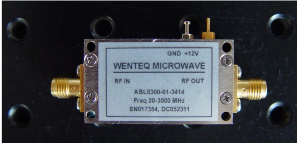
Figura 50: Amplificador LNA de 39 [dB] de ganancia.
