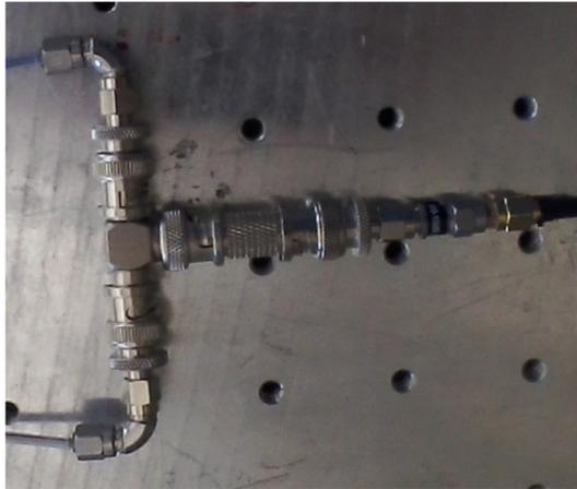
Figura 56: Divisor T simple implementado con conectores SMA/BNC.
