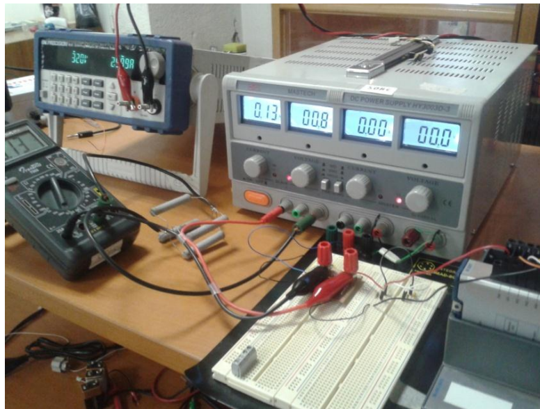
Figura 3.36: Conexiones para la calibración del sensor de corriente
