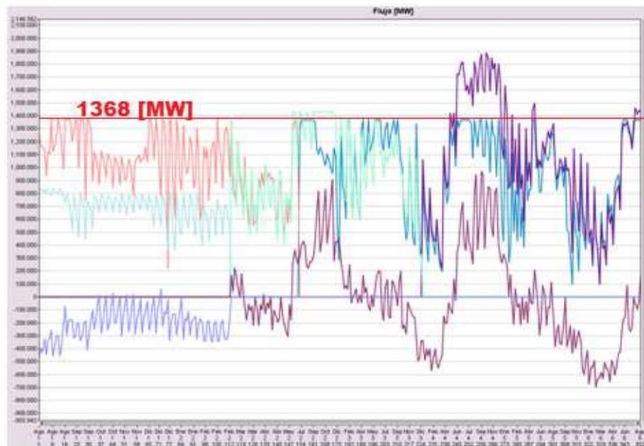
Figura 10: Flujos de potencia en sistema de transmisión 500 [kV] para una hidrología seca
