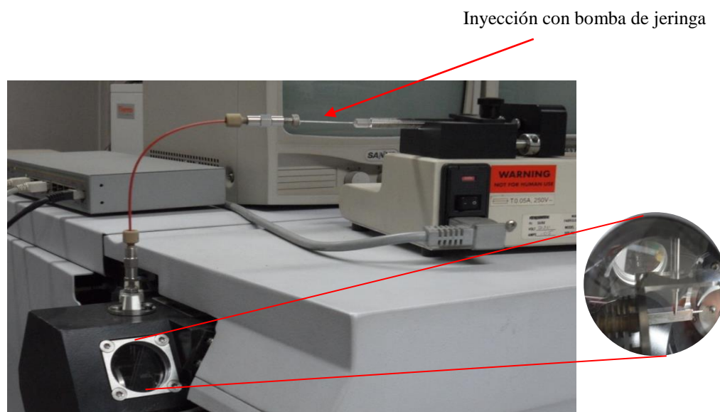
Figura 1. Configuración utilizada para una inyección directa en la fuente de ionización. La imagen circular muestra un acercamiento de la fuente de ionización, en la cual se aprecia el nebulizador.
