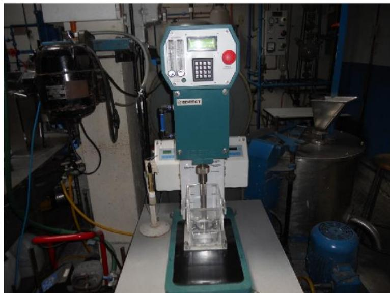
Figura1. Celda de flotación utilizada en los experimentos.
