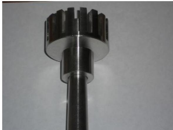
Figura2. Celda de reacción y mezclador de turbina.
