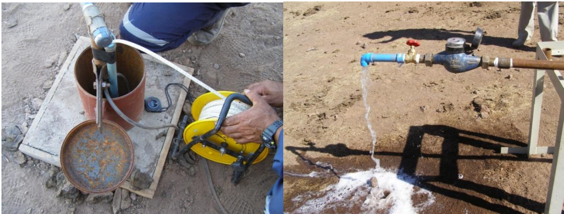
Figura 15.- Registro fotográfico de la prueba de bombeo en el Sondaje S4.
