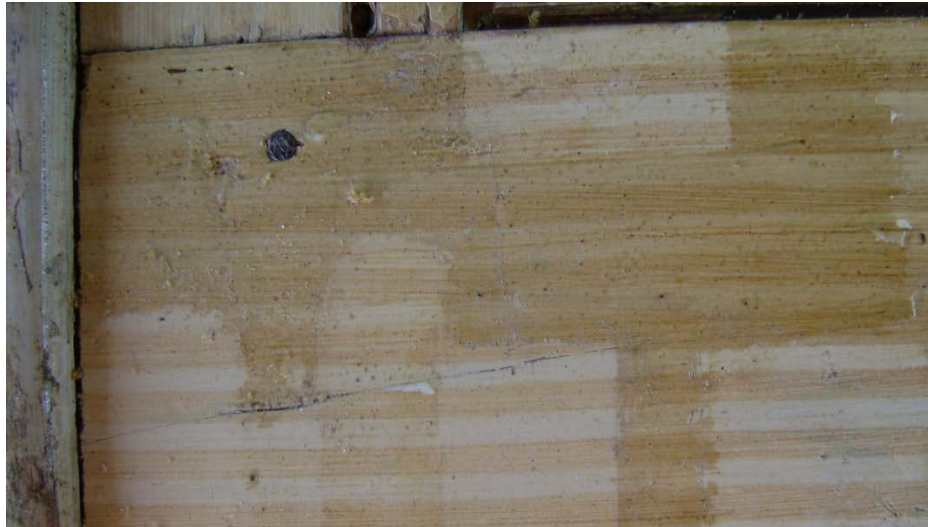
Imagen 44: detalle test de solubilidad
