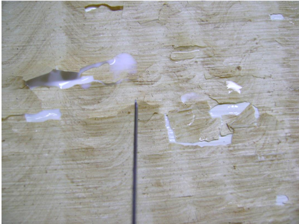
Imagen 62: detalle inyección de mowilith en puerta vitrina NM5
