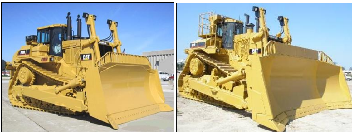
ILUSTRACIÓN 33: IMAGEN DE EQUIPOS D10R (IZQUIERDA) Y D11R (DERECHA)
