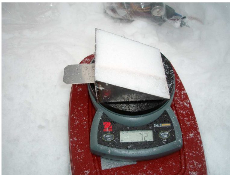
Figura 3-2. Mediciones de densidad de nieve con cuña. Fuente: U.S. Geological Survey. 2
