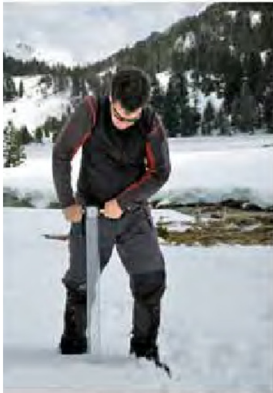
Figura 3-3. Mediciones de densidad de nieve con tubo. Fuente: Fassnacht et al., 2010.
