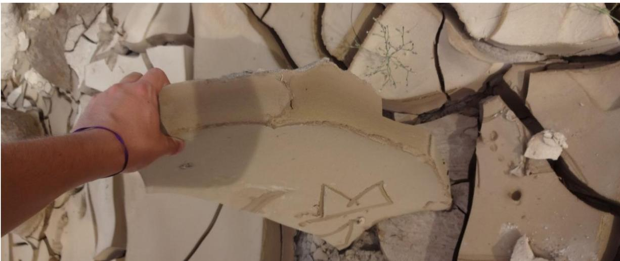
Figura 4-11: Sedimentación de material fino
