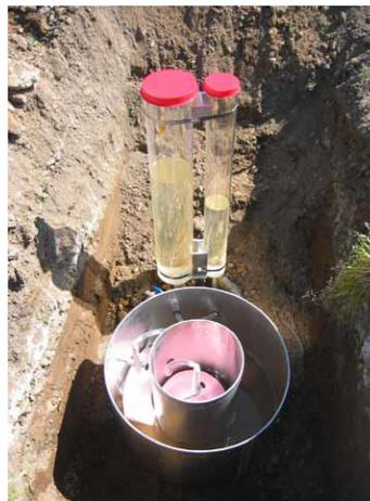
**Figura C-12: Infiltrómetro de doble anillo a carga constante. Instalación experimental.**
