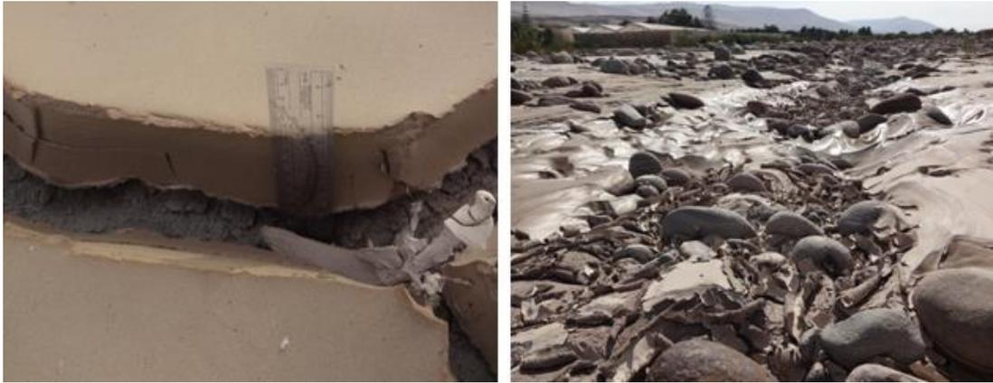
**Figura C-3: Sedimentación material fino en alto estancamiento (izquierda). Sedimentación material fino en bajo estancamiento (derecha).**
