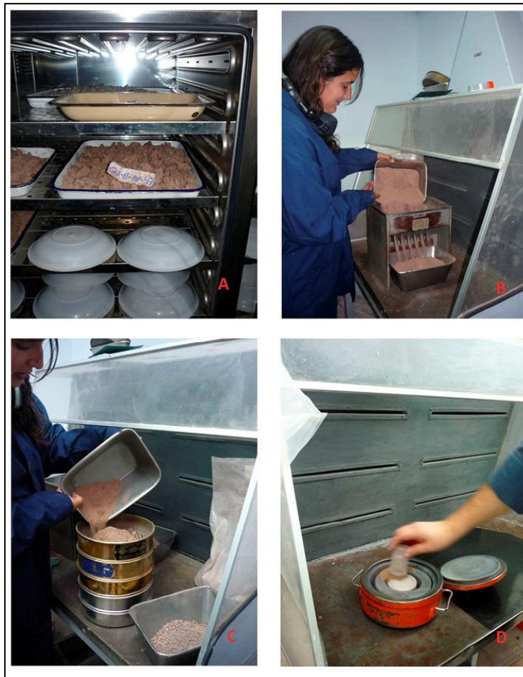
Figura 3. 4. Metodología de laboratorio. A: secado en horno a <27^{\circ}\text{C}</math>. B: Cuarteado. C: Tamizaje y separación de fracción fina ( <180\ \mu\text{m}</math>). D: Pulverización de mortero de ágata.
