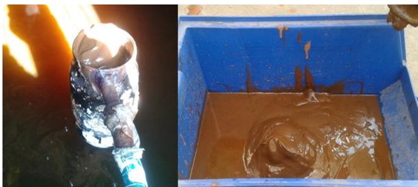
Figura 15: Muestras extraídas del fondo del absorbedor en la planta de CO 2 .
