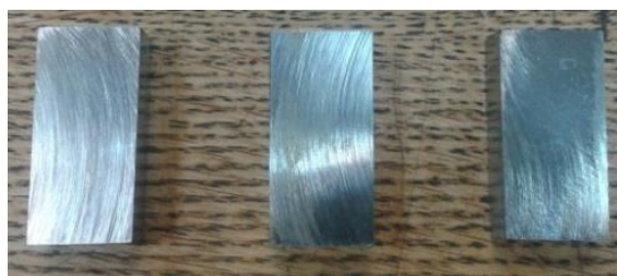
Figura 13: Cupones de acero ASTM A36.
