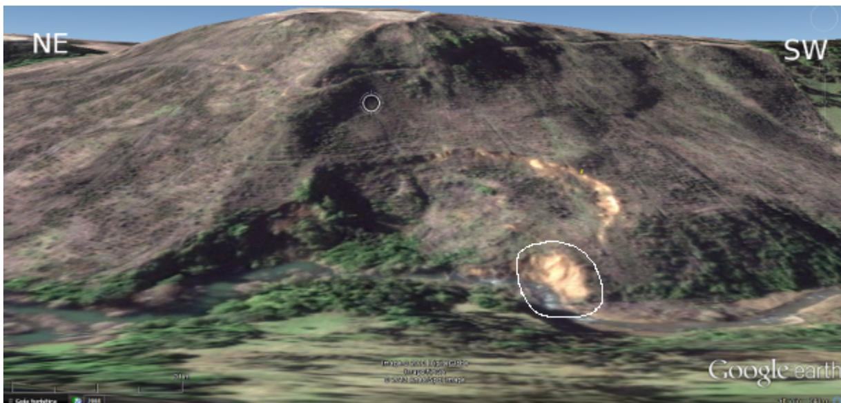
Figura 4.4: Dos deslizamientos en Curanilahue, Octava Región. Deslizamiento rotacional en la parte central de la imagen, donde se aprecia el escarpe de esta nueva remoción en la parte SW de una antigua remoción. Deslizamiento traslacional en la zona inferior SW, que se destacó en la imagen encerrandola en un círculo rojo. Imagen extraída de *Google Earth*, sitios 87 y 201 del Anexo A.
