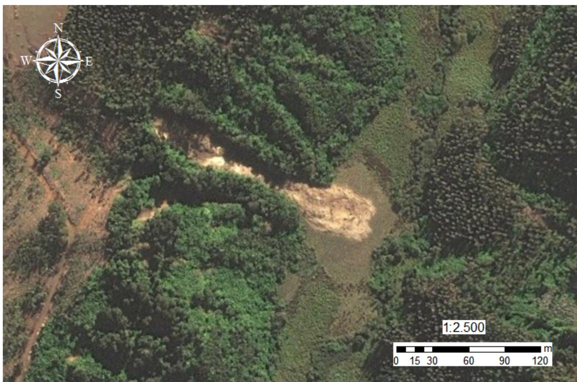
Figura 4.16: Flujo de barro en ladera oeste estero Ranquilco, Los Alamos, sitio 136 del Anexo A. Imagen obtenida de base de datos de imágenes de Arcgis
