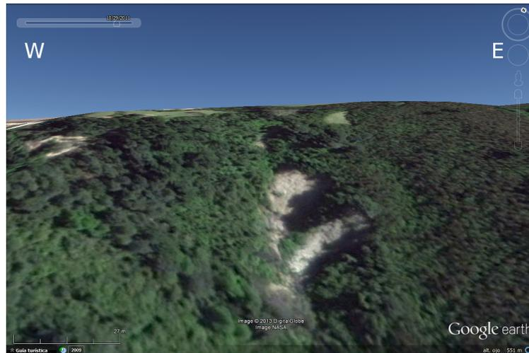
Figura 4.13: Procesos de remoción en masa mixto. Cordillera de Nahuelbuta, comuna de Los Alamos, Octava Región. Imagen extraída de *Google Earth*, sitio 83 y 84 de Anexo A
