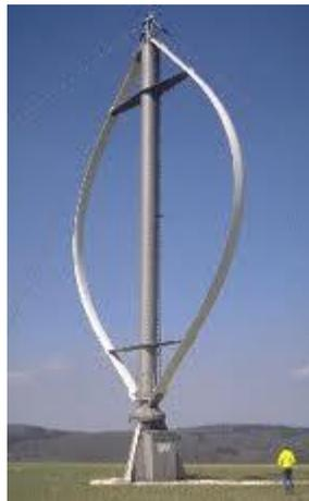
Figura 2.9: Aerogenerador de eje vertical
