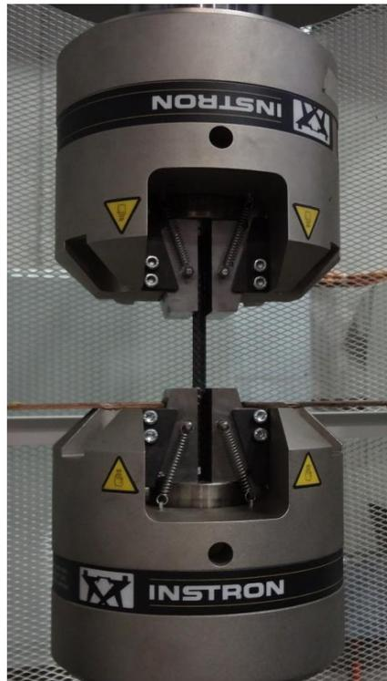
*Figura N° 3.1 - maquina universal para pandeo Instron modelo 600LX de 60 toneladas*
