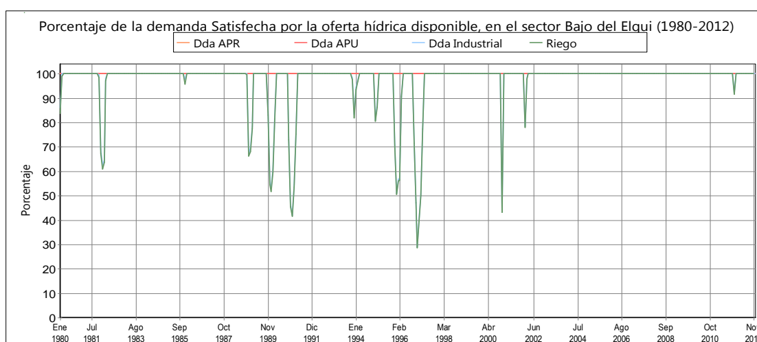
Figura 4.4.1: Gráfico porcentaje de la demanda satisfecha por la oferta hídrica disponible en el sector bajo del Elqui (1980-2012)
