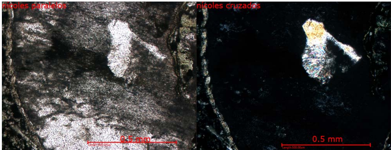
Fotografía 3. Amígdala rellena con el mismo mineral anterior, pero con un mineral no identificado al centro de alta birrefringencia, con hábito acicular radial, podría tratarse de mica blanca, se repite en otras amígdalas, pero con cristales de menor tamaño.
