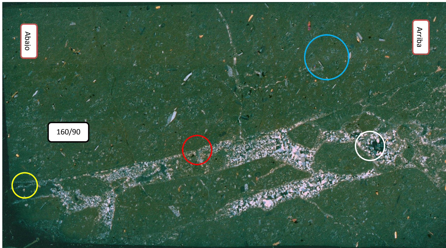
Fig. A.1 63: Escaneo polarizado del corte MF41v. Como el corte es vertical, se indica la posición y la orientación de la veta.
