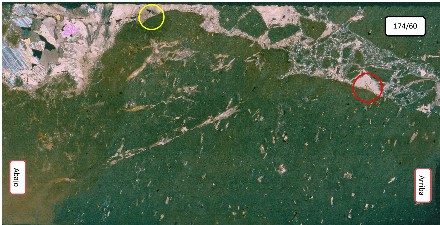
Fig. A.1 51: Escaneo polarizado del corte MF34v. Como el corte es vertical, se indica la posición y la orientación de la veta.
