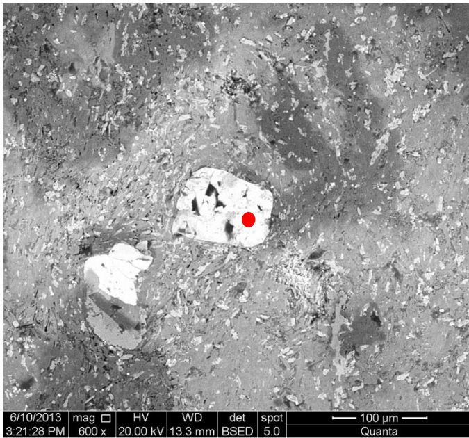
Fig. A.4 7: Imagen SEM-BSE. Rojo: óxido Fe-Ti.
