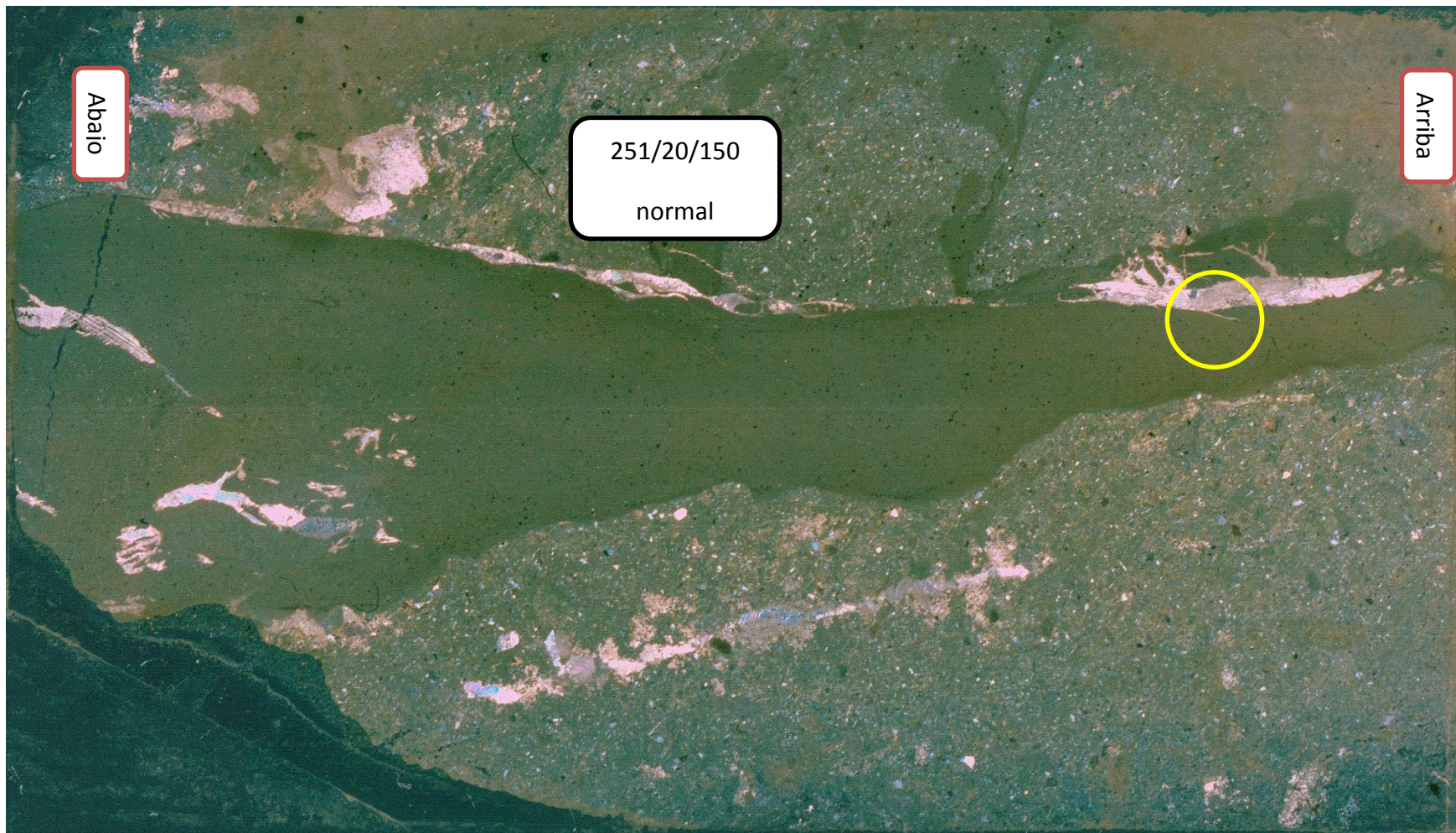
Fig. A.1 48: Escaneo polarizado del corte MF27rb. El corte está hecho paralelo al rake y perpendicular al plano de falla.
