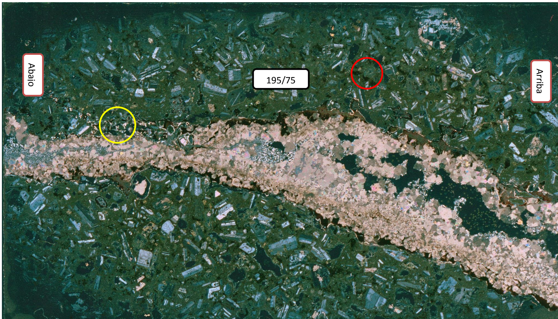
Fig. A.1 35: Escaneo polarizado del corte MF22v. Como el corte es vertical, se indica la posición y la orientación de la veta.
