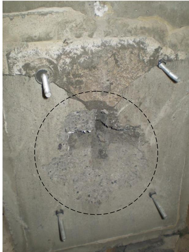
Figura 2.26: Zona de rotura en el hormigón, Llave de corte N°6 (Palma, 2008)
