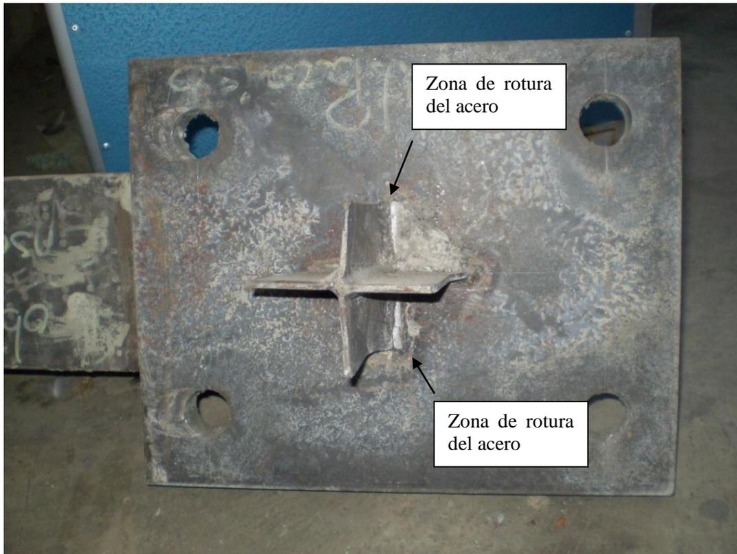
Figura 2.20: Zona de rotura del acero, Llave de corte N°1 (Palma, 2008)
