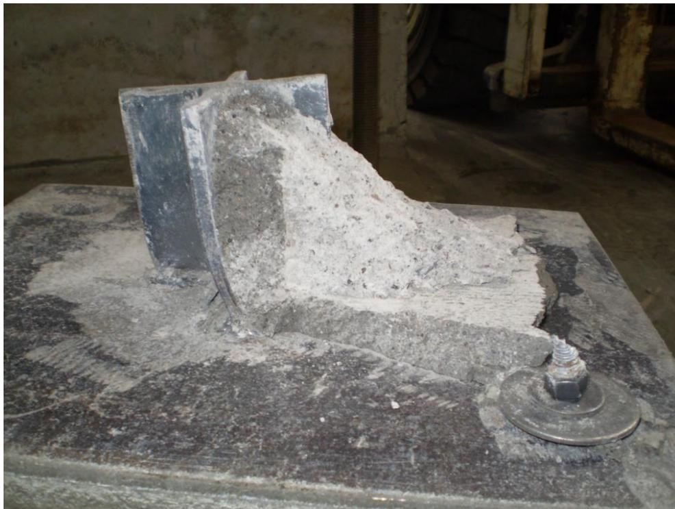
Figura 2.23: Zona de rotura en el hormigón, Llave de corte N°4 (Palma, 2008)
