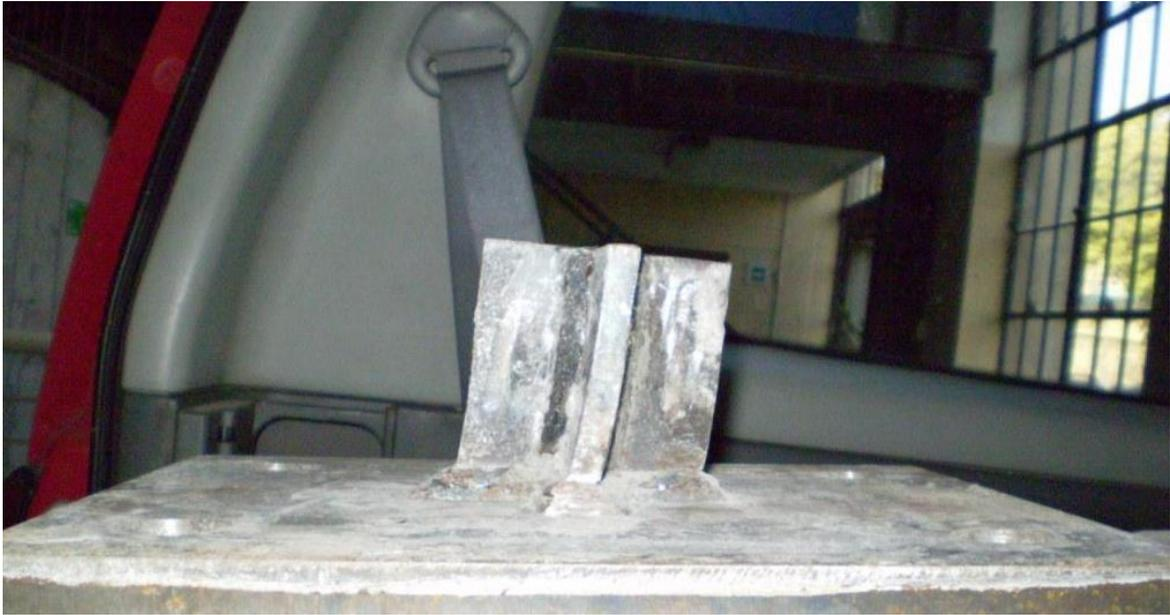
Figura 2.25: Deformación en Llave de corte N°6 (Palma, 2008)
