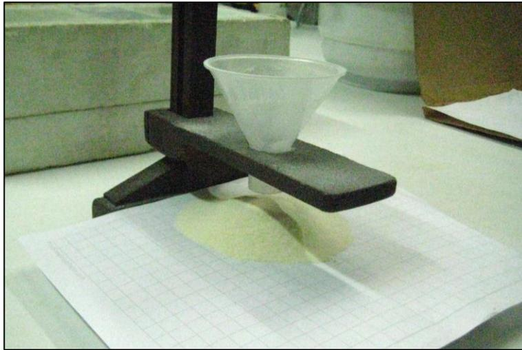
**Figura 3.3: Equipo utilizado para determinar ángulo de reposo.**
