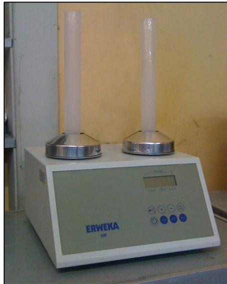
Figura 3.2: Equipo ERWEKA EVM (Alemania) utilizado para determinar densidad bulk.
