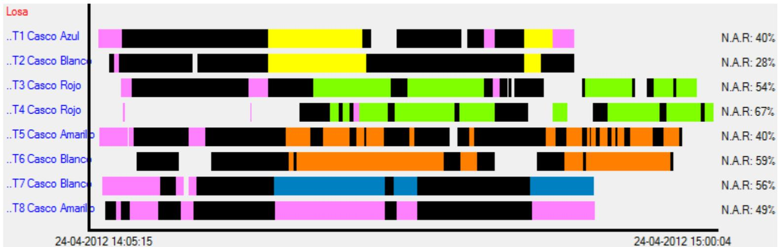
Figura 39: Carta de balance hormigonado de losa, 24 de abril.
