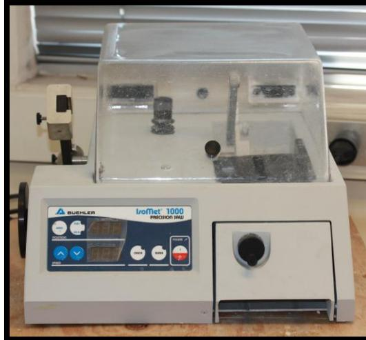
Fig. N° 6 Recortadora ISOMET BUEHLER LER LAKEBUFF IL, USA.
