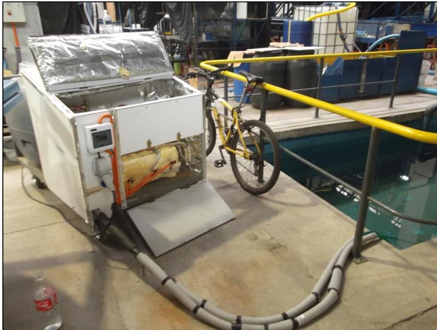
Anexo F.1: Instalación del equipo TRT en laboratorio para la medición del aporte calórico de la bomba.
