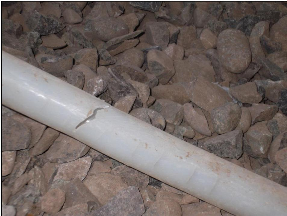
Anexo A.4: Tuberías correspondiente al circuito de la Pila 101 quebrada debido a pérdida de flexibilidad por radiación (03-04-2013).
