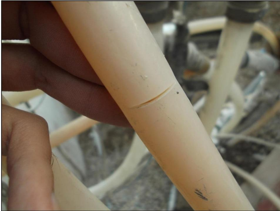
Anexo A.3: Corte en una de las tuberías del circuito de los anclajes (03-04-2013).
