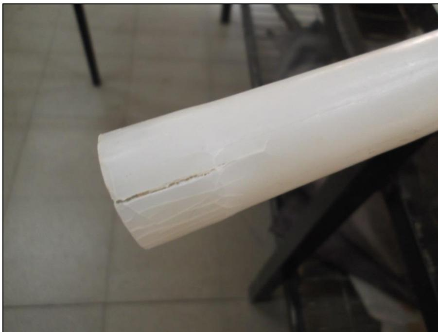
Anexo B.2: Detalle de muestra de tubería sacada de terreno quebrada al tratar de ser expandida (04-04-2013).
