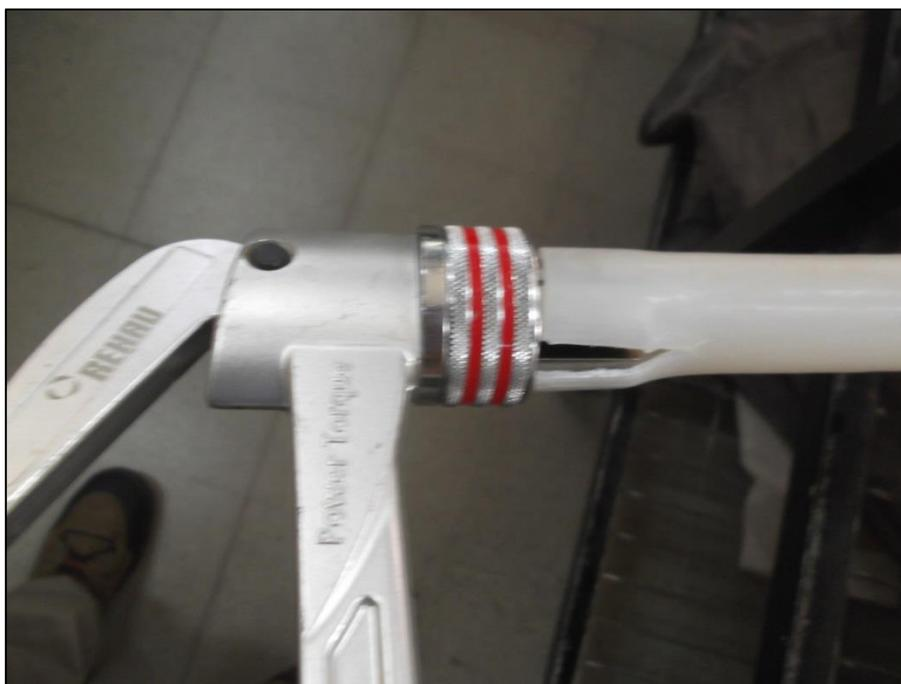
Anexo B.1: Muestra de tubería sacada de terreno quebrada al tratar de ser expandida (04-04-2013).
