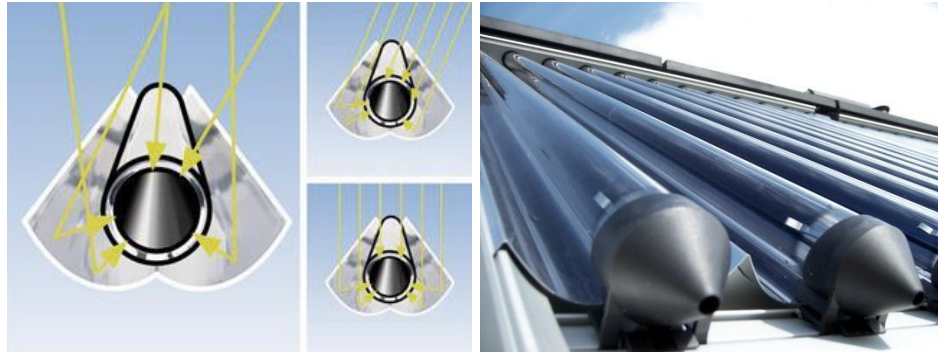
Figura 4: Esquema y disposición real de colectores CPC.
