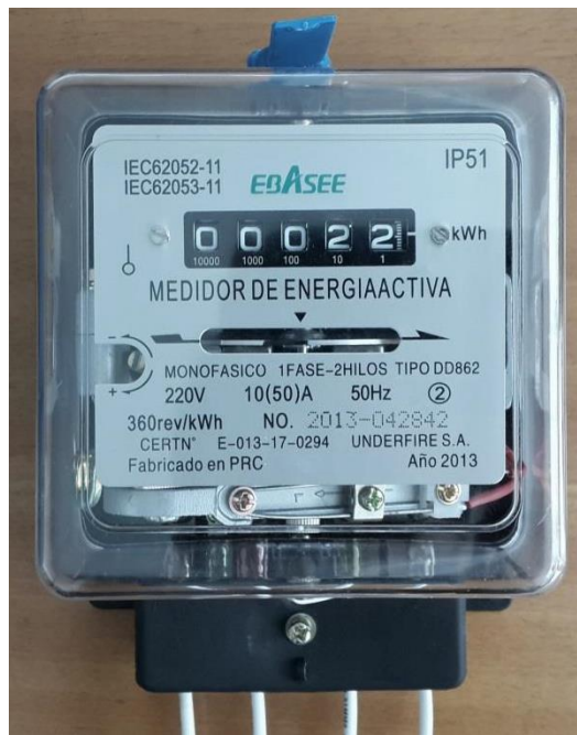
Figura 26: Remarcador de energía activa
